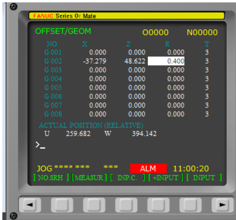
Gambar .... menu tool offset yang berisi data kompensasi panjang alat potong, radius, dan tipe alat potong
